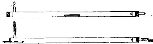
Der Stopfen im Innern des Rohres schneidet mit der Mündung des Ansatzes ab.
